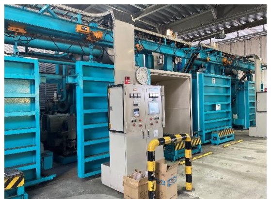
↑長距離輸送に対応するための真空保冷库 ダイコンは福岡へも輸送しています
